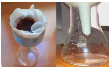
Figure 2.21 : Les étapes de filtration et lavage.
