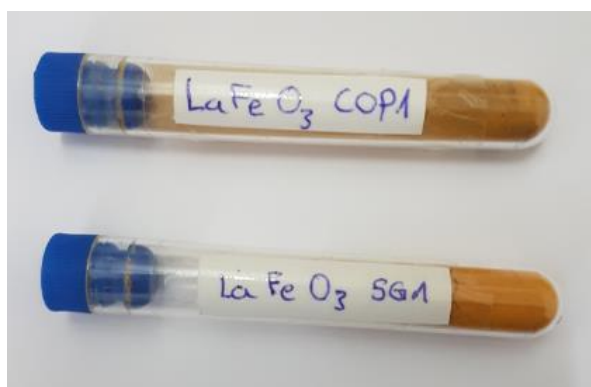
Figure 3.1 : Les poudres \text{LaFeO}_3 obtenues après les synthèses.
