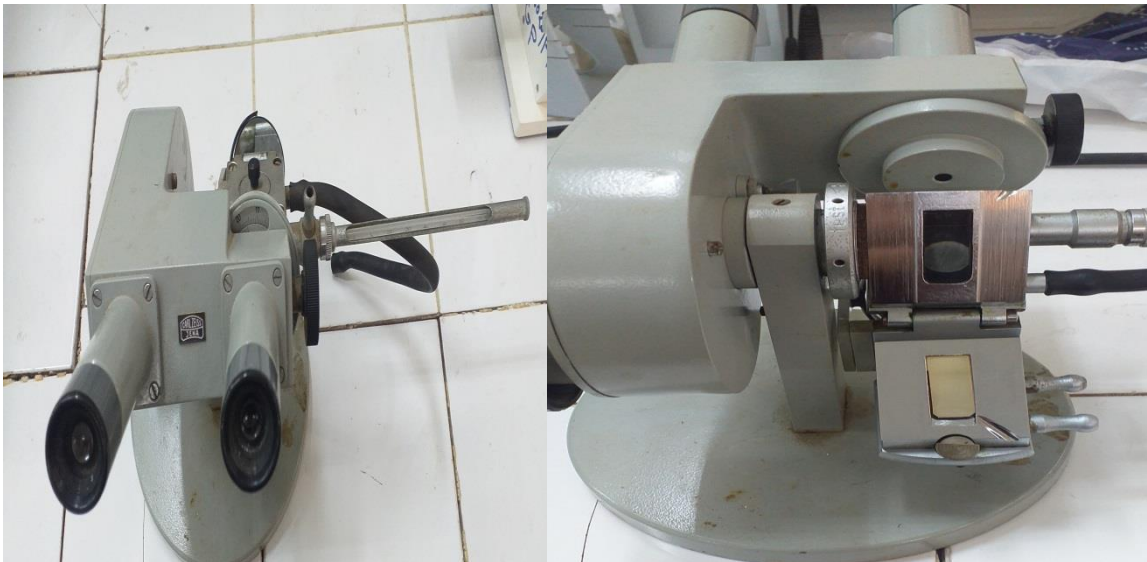
Figure : Dispositif expérimental d'un appareil de l'indice de réfractomètre.
