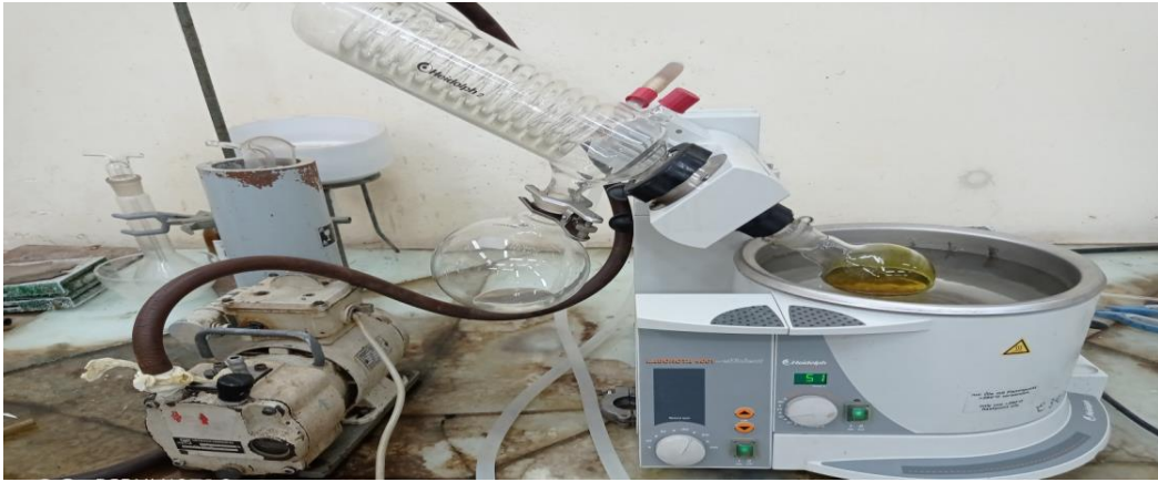
Figure : Dispositif expérimental d'un appareil Vaporisateur rotatif.
