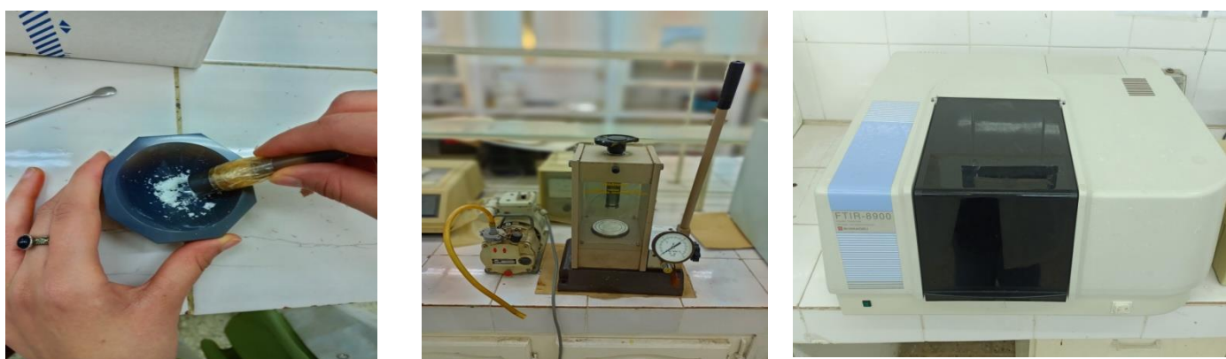
Figure IV.10: Les différentes étapes de préparation des pastilles pour l'analyse IR.
