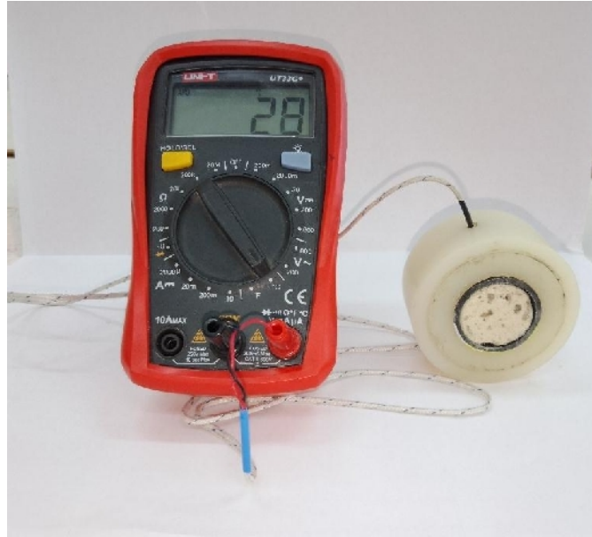
Figure 2.7. Échantillon en PVC avec thermocouple
