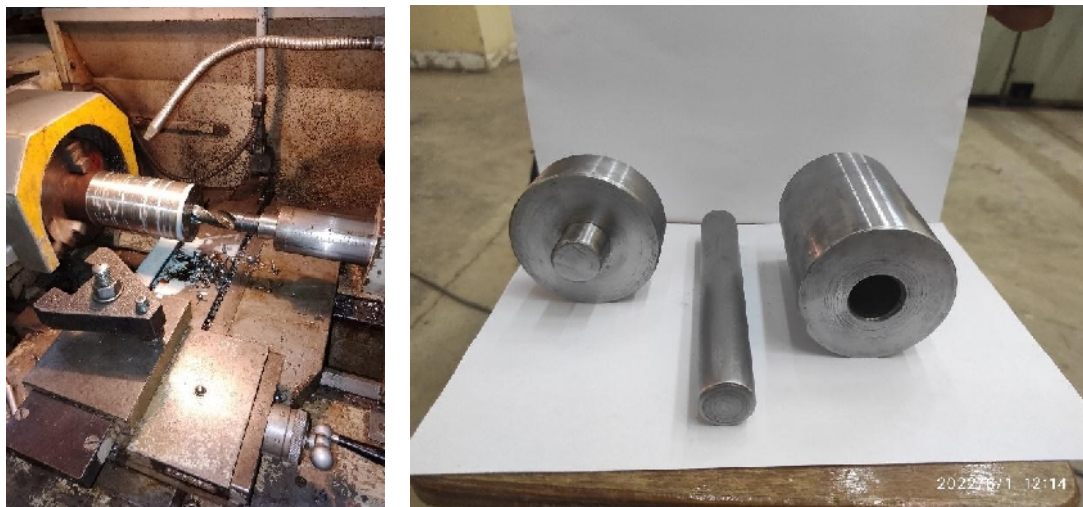
Figure. 2.4. Matrice de compactage, usinage et forme finale.
