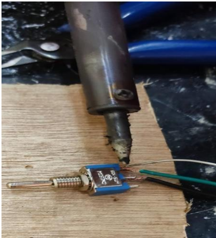
Figure (6.15) : Câblage des Switch
