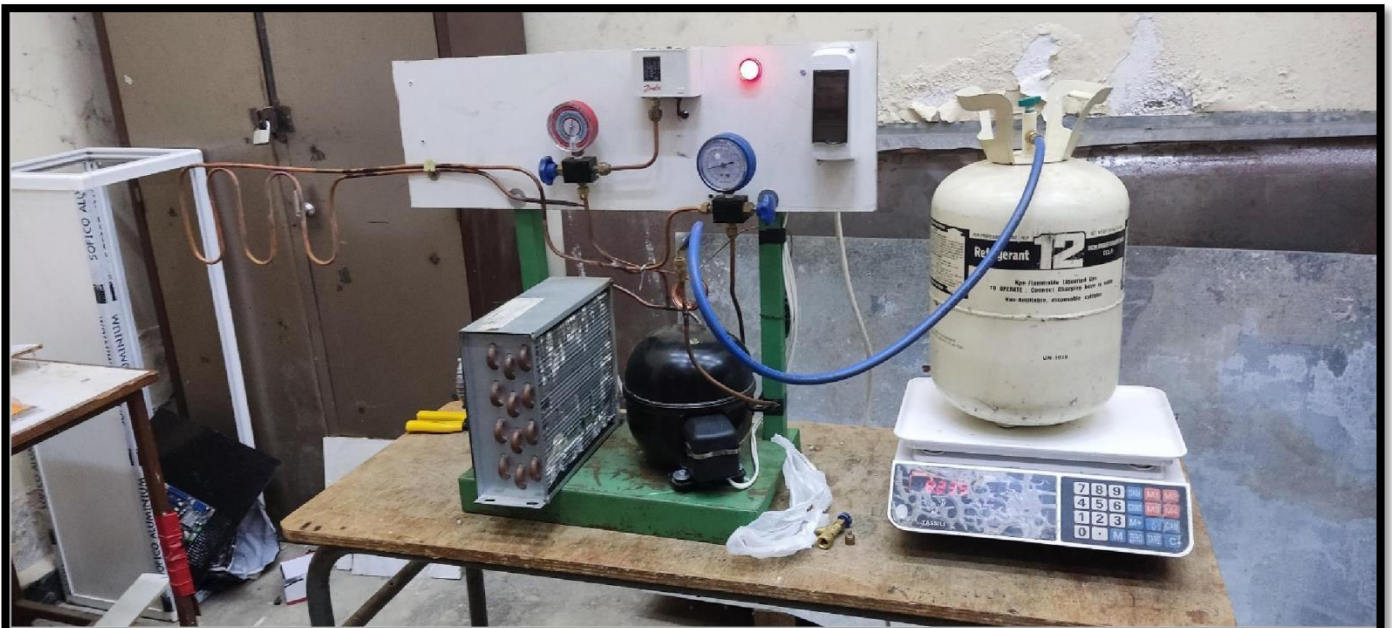
Figure (5.16) : Remplissage Du Gaz Frigorigène (R12).
