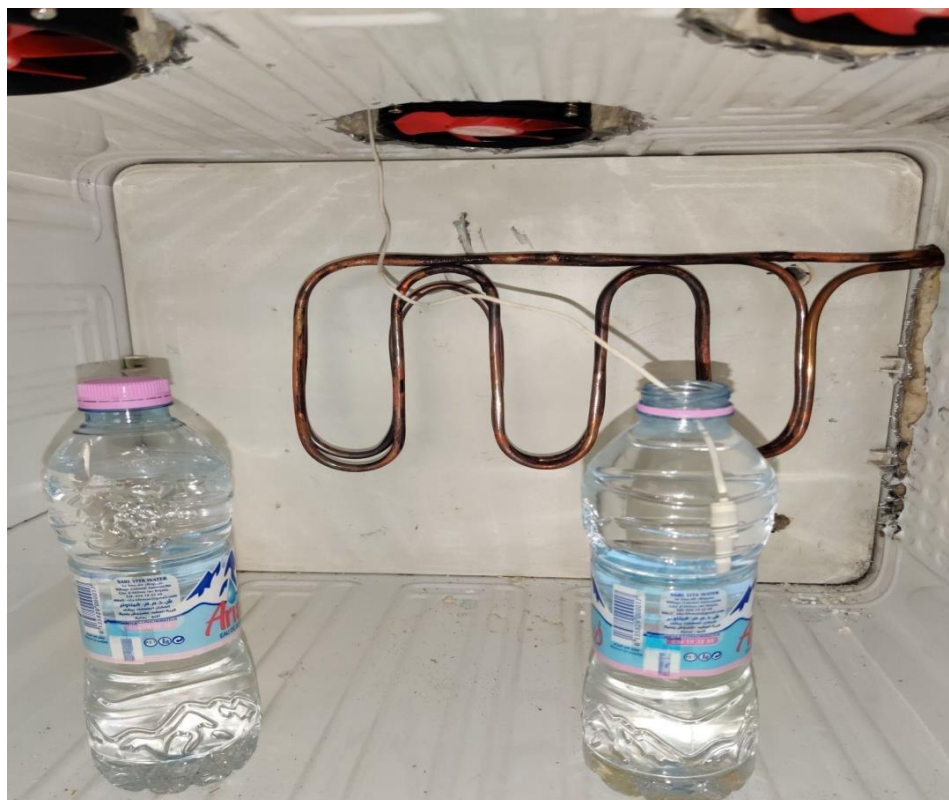
Figure (6.22) : le rentré d'échangeur dans le frigo.
