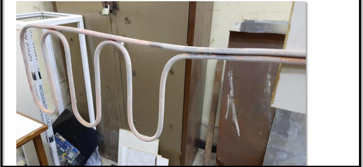
Figure (5.17) : début de congélation de l'échangeur.
