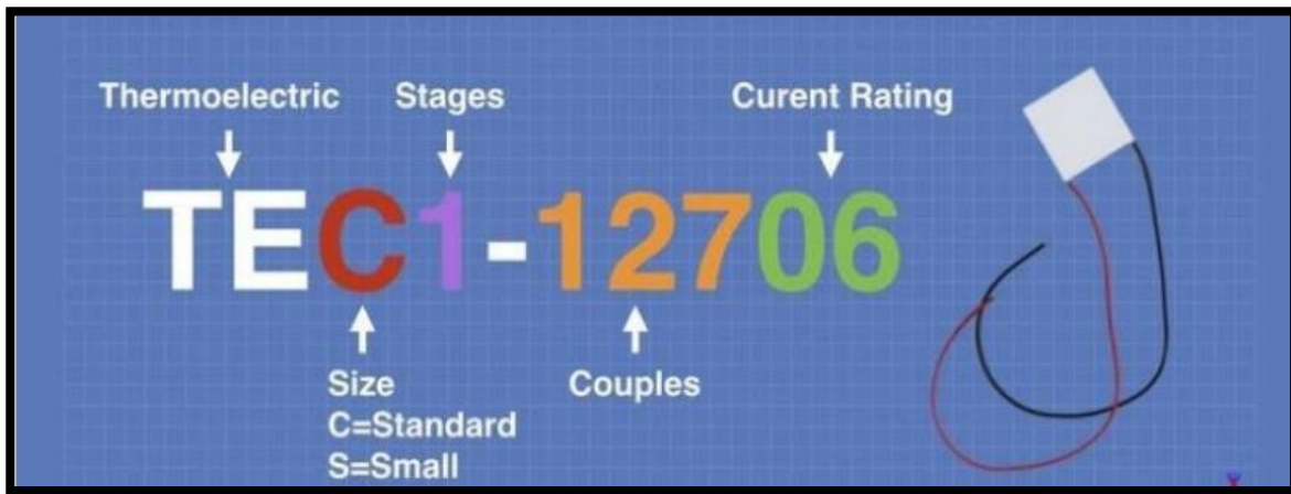
Figure (2.3) : Signification d'un module Peltier
