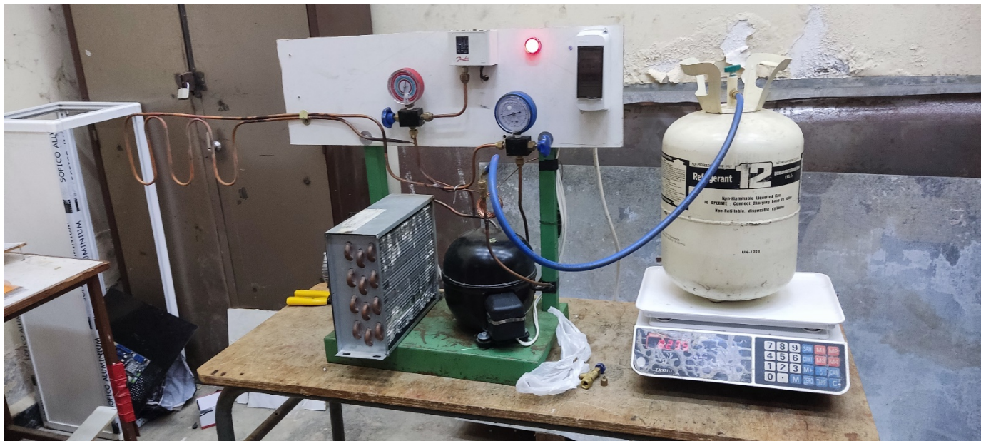
Figure 47 : Remplissage Du Gaz Frigorigène (R12)
