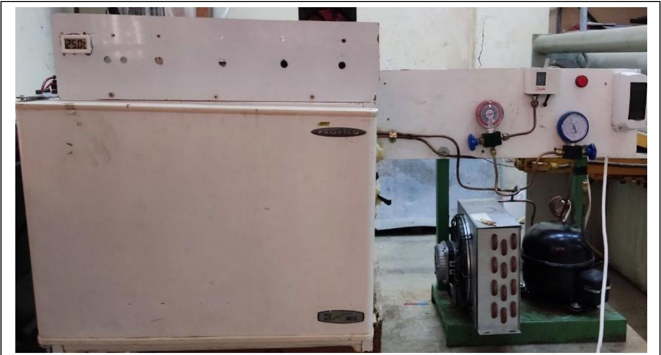
Figure 5-12 : L'assemblage final de la machine frigorifique a compression de vapeur.
