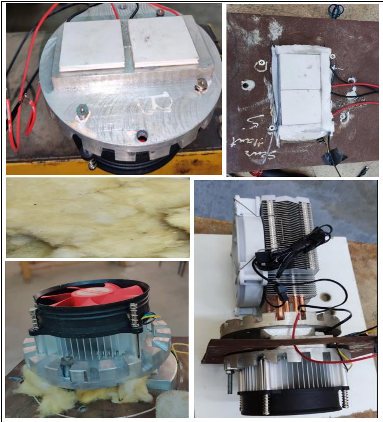
Figure 6-7 : Assemblage du module de refroidissement.
