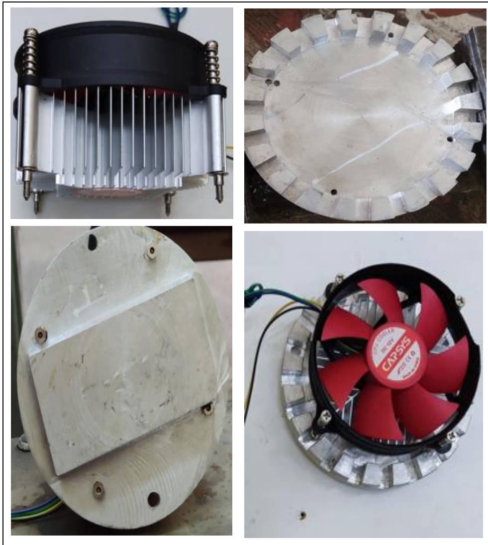
Figure 6-6 : Fixation du ventilateur avec le 2 e radiateur.
