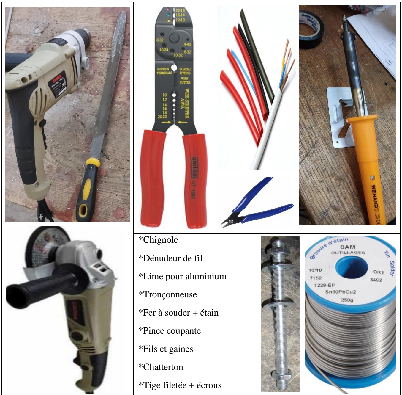
Figure 6-1 : Outillage nécessaire pour la réalisation du système de refroidissement thermoélectrique.
