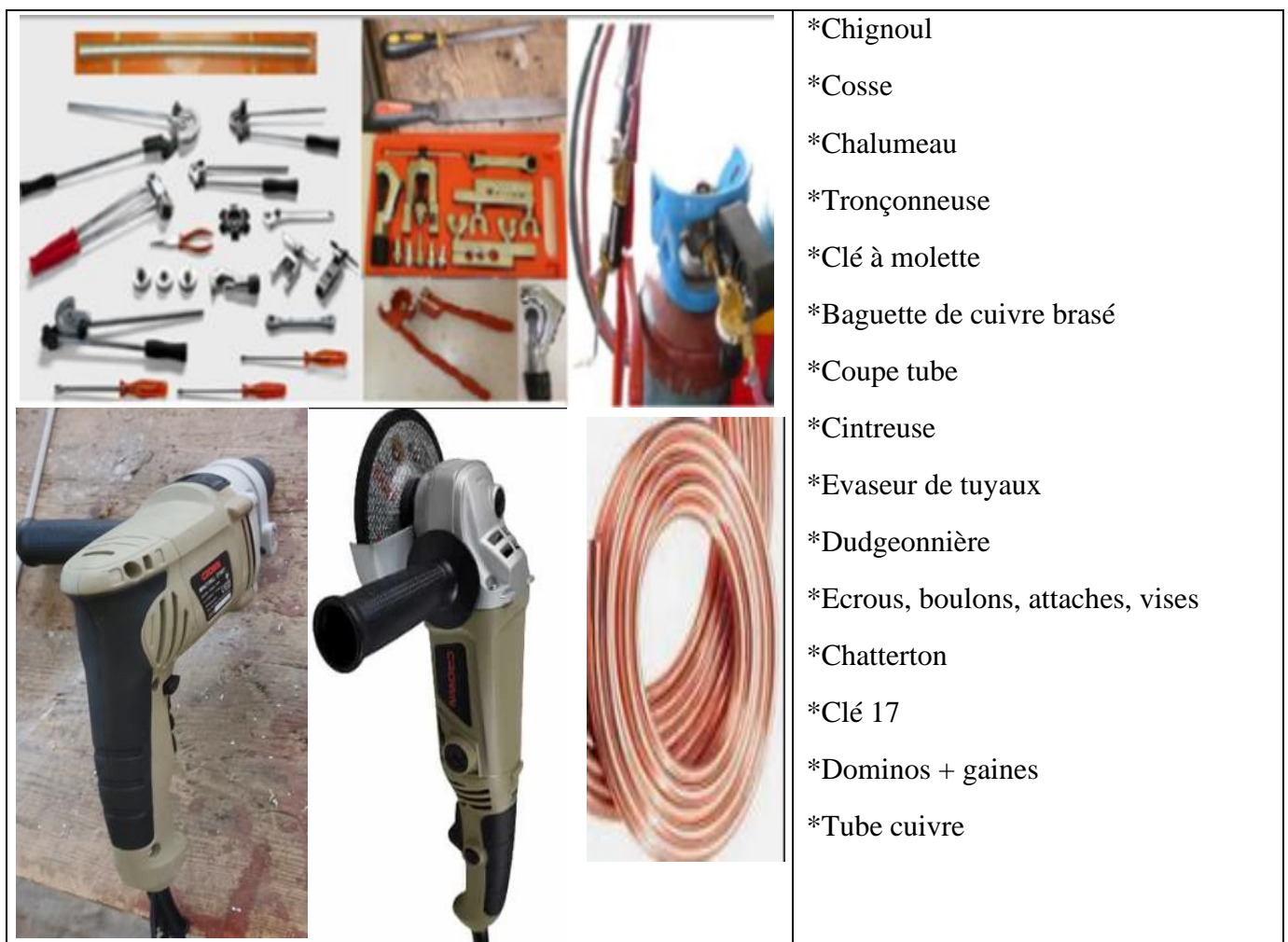
Figure 5-1 : Outillage utilisé pour la réalisation de la machine frigorifique à compression.
