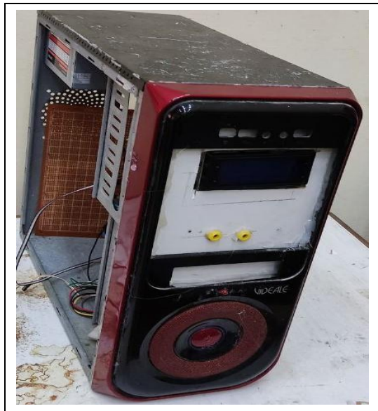
Figure 7-22 : Montage de l'afficheur LCD.
