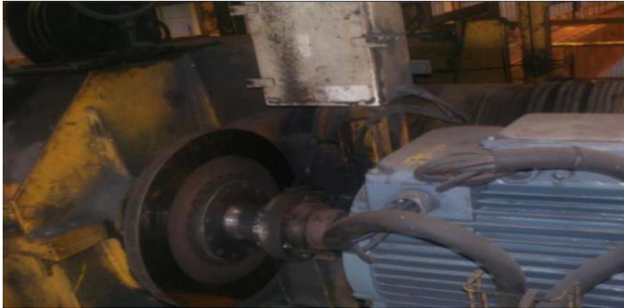
**Fig. II.14** Photographie d'un frein à disque.
