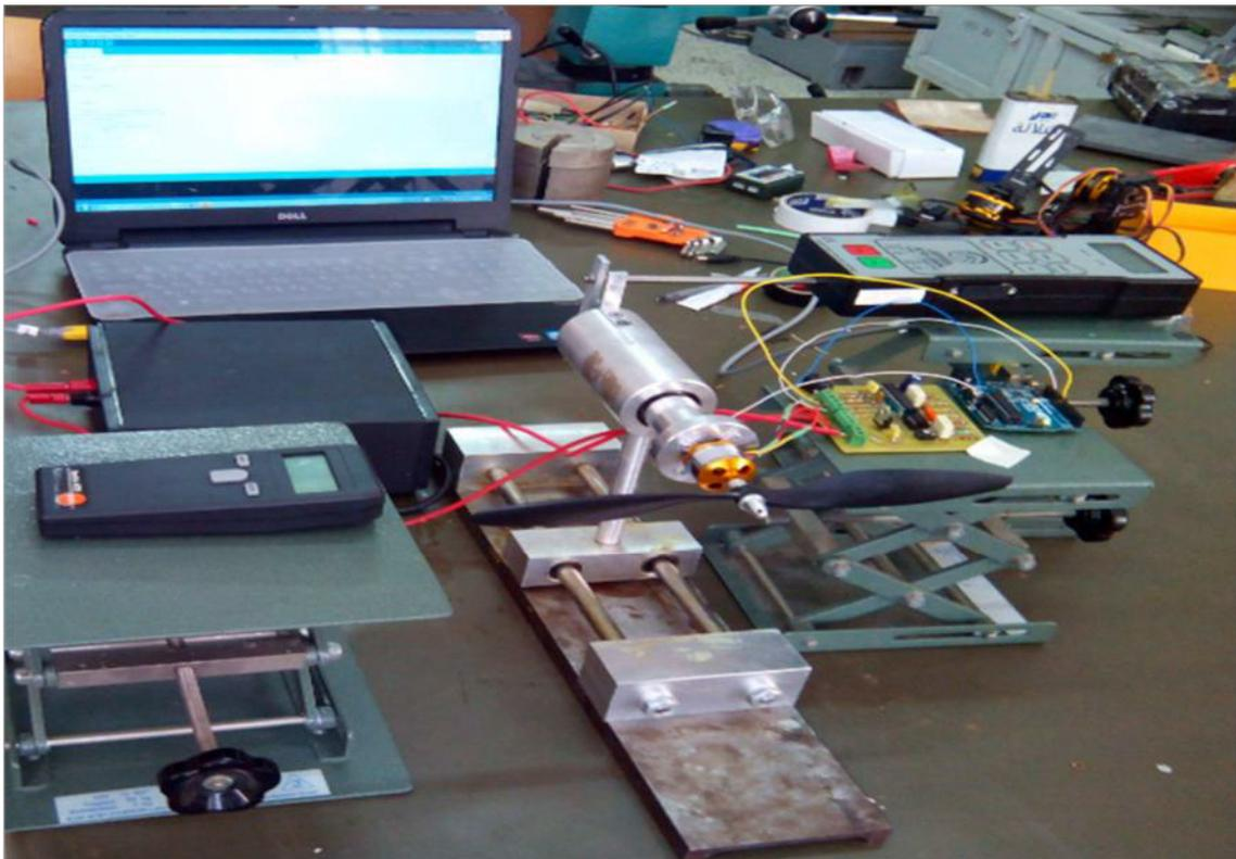
Figure IV-10 : Le montage de mesure des caractéristiques de l'hélice APC 10x4.5''SF.
