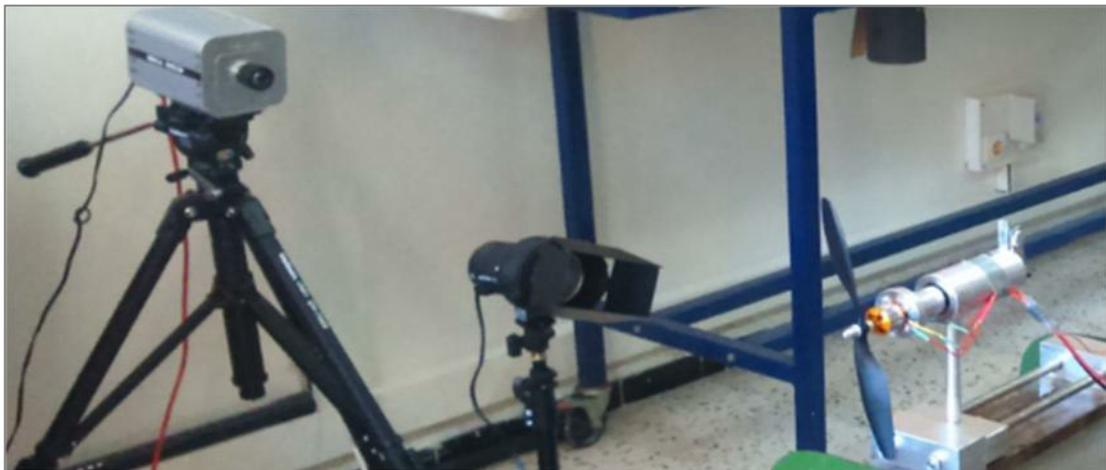
Figure IV-11 : L'installation de la caméra Mega Speed pour la mesure de la vitesse d'avancement.
