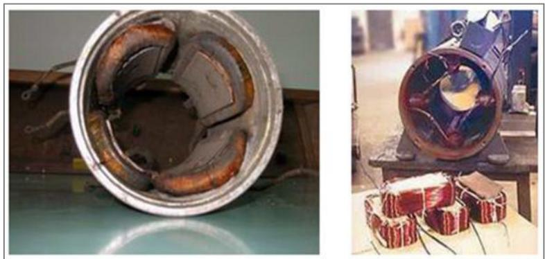
Figure I-5 : Inducteur d'un moteur à courant continu.
