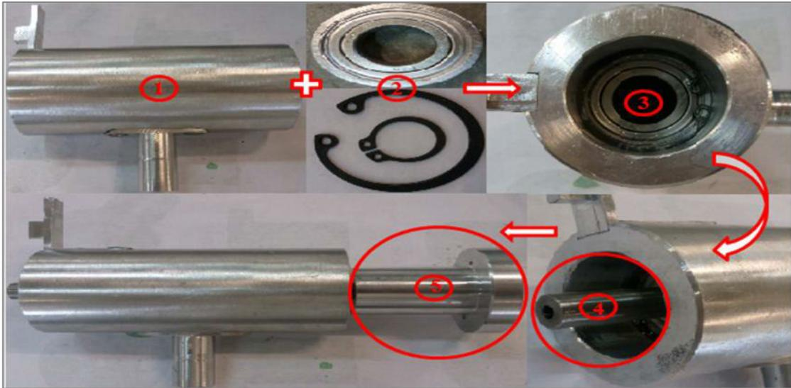
Figure III-6 : L'assemblage des pièces de la partie Fixation-moteur.
