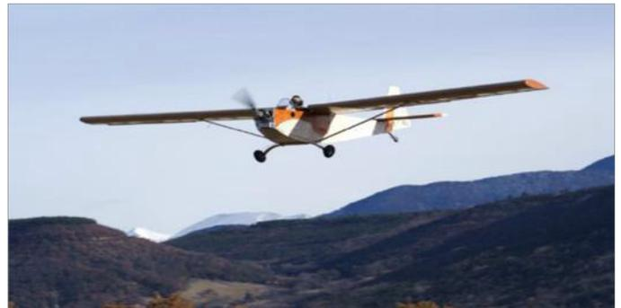
Figure I- 15 : le premier avion électrique Electra BL1.
