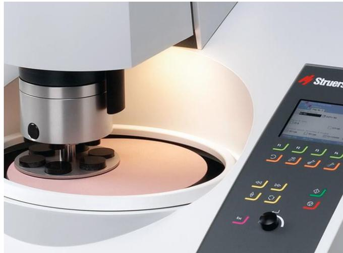
**Figure 3.5 : Dispositif expérimental de polissage**
