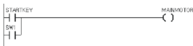
Figure 4.3. Circuit électrique sous LADDER avec des alias.
