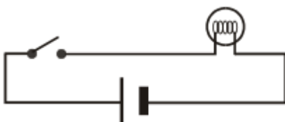
Figure 2.5. Circuit électrique simple.
