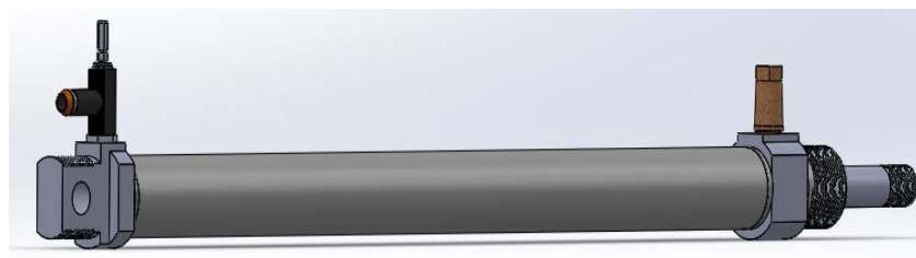
Figure 3.12. Un vérin simple effet.
