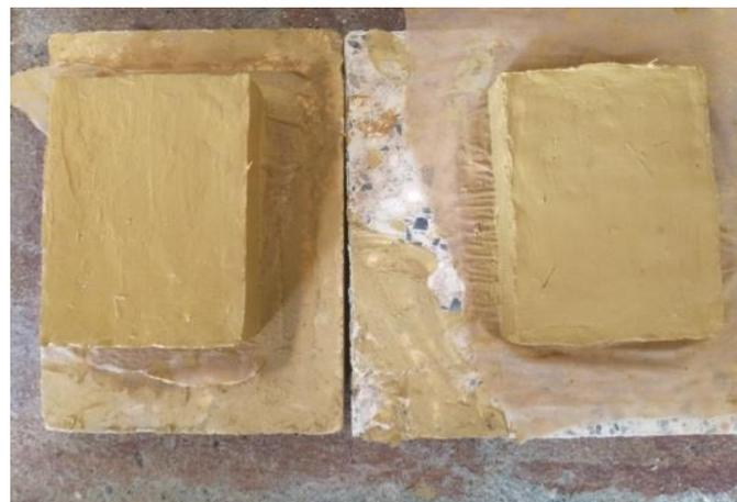
Figure 2.26 : Séchage des éprouvettes du revêtement 1 à l'air libre ©.
