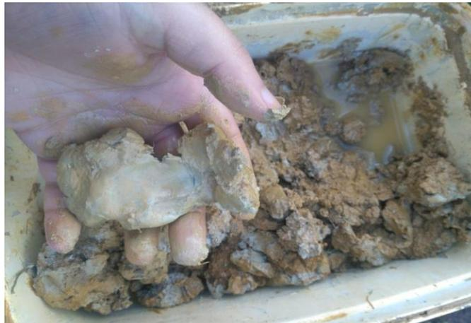
Figure 2.33 : Argile immergée dans de l'eau durant 24 heures ©.
