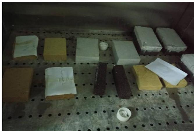
Figure 2.42 : Séchage des éprouvettes dans une étuve ©.
