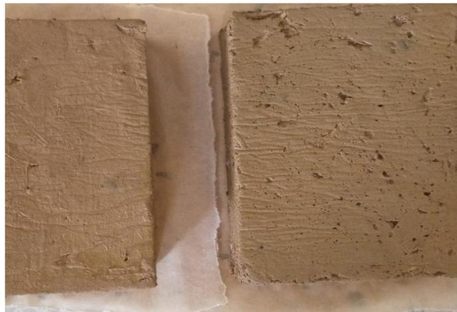
Figure 2.29 : Séchage des éprouvettes du revêtement 2 à l'air libre ©.
