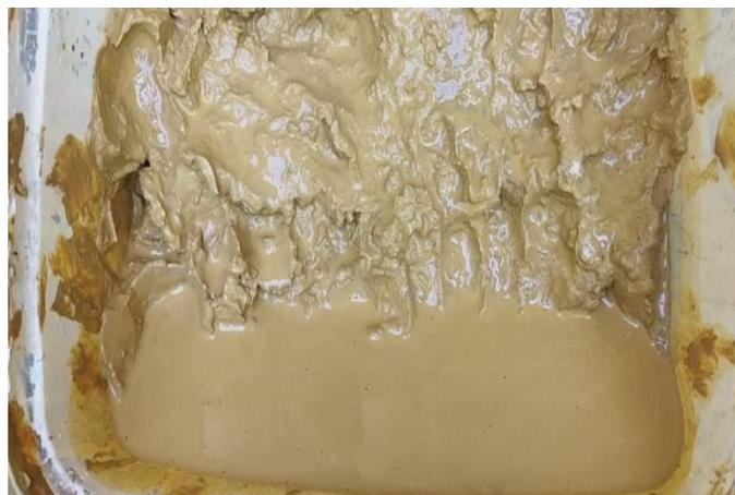
Figure 2.24 : Pétrissage de la terre argileuse ©.
