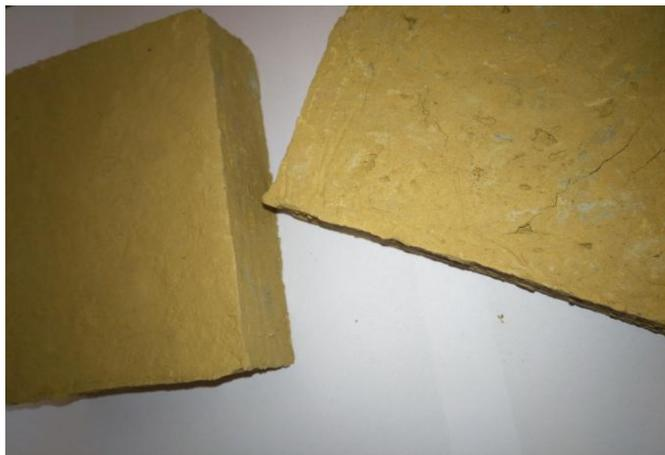
Figure 2.34 : Séchage des éprouvettes de mortier à l'air libre ©.
