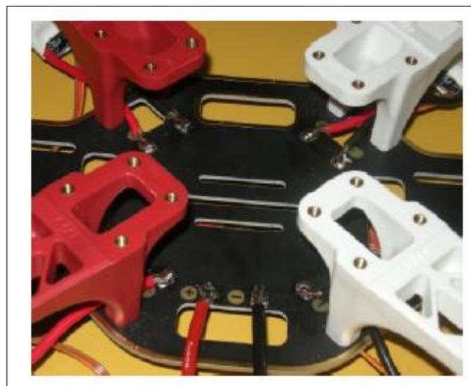
**Fig.IV.6 :** Les câbles d'alimentations sont soudés sur la "PowerBoard".
