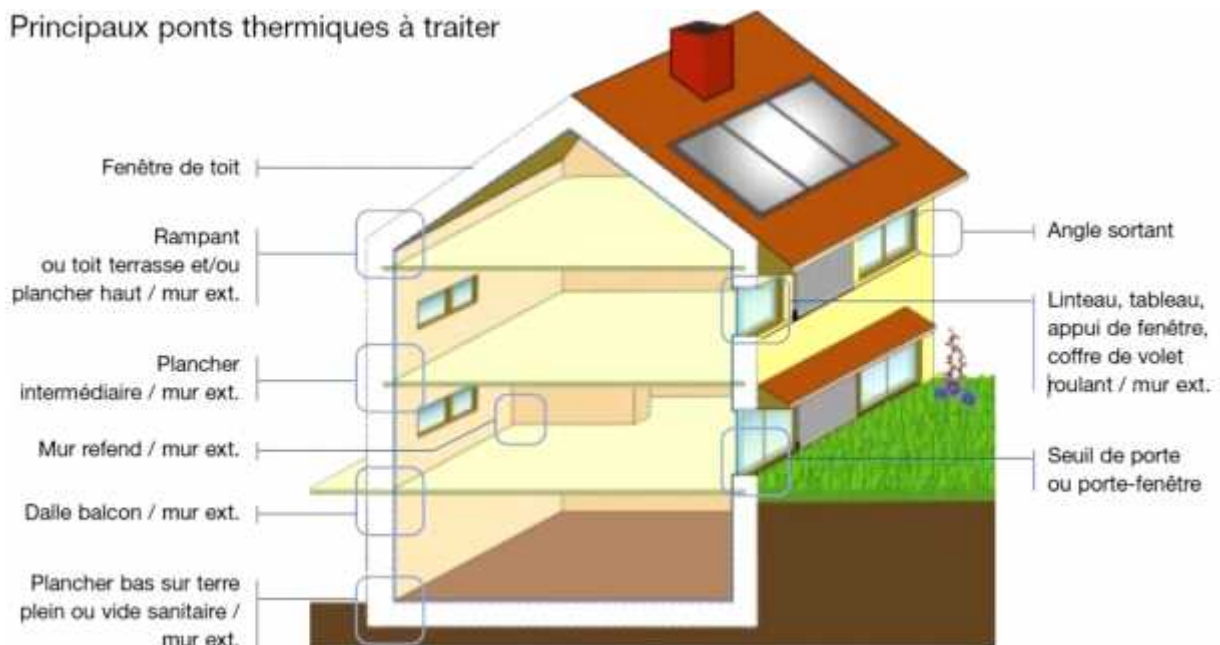
Figure 12 Situation des ponts thermiques ( Source : www.effenergie.org )
