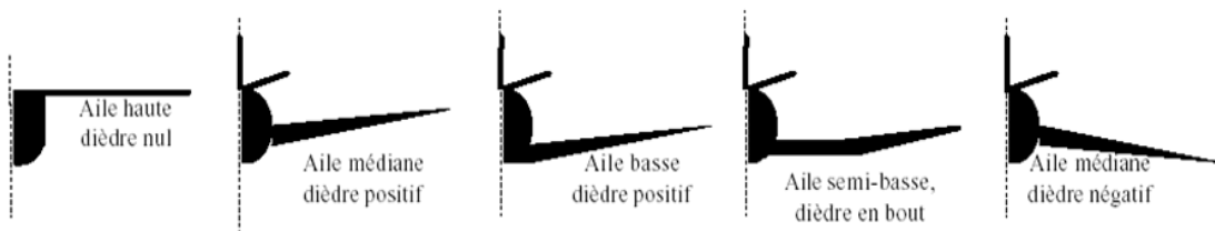
Figure (II.9) : positions possibles de l'aile et du dièdre
