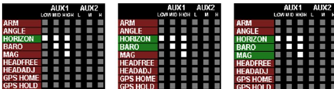
Figure B.3 : Modes de vol enclenchés en fonction de la position du potentiomètre
