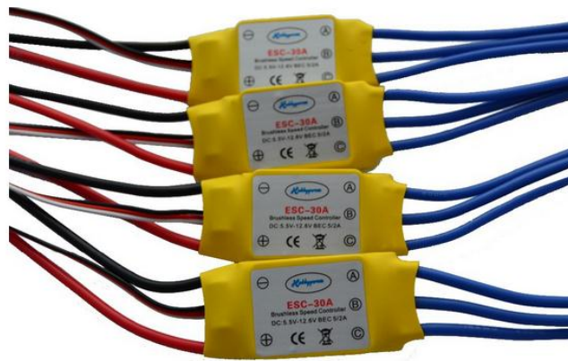
Figure IV.3 : Contrôleur de vitesse Fun Fly 30A
