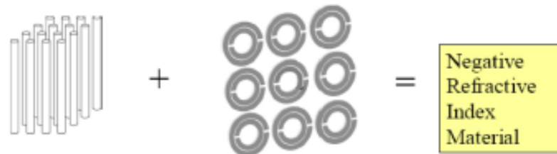
Figure 1.5 Combinaison de fils fins et de SRR (Aos Al-waidh 2009) [8].
