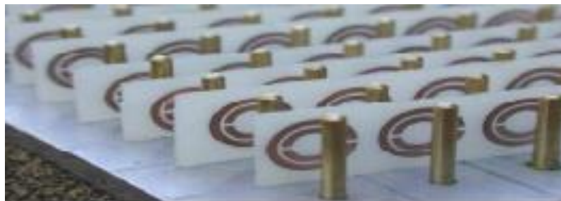
Figure 1.2 Premier réseau de structures d'essai à gauche réalisé par le Groupe de San Diego (D R Smith) [5].
