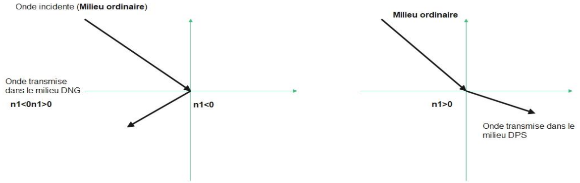
Figure 1.3 Comparaison de la loi de Snell dans des milieux différents.
