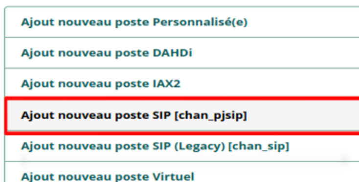
Figure 3.7 : Ajouter une nouvelle extension Sip [chan_pjsip ].
