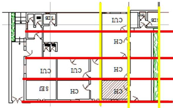
Figure 3.36 : Trame du système constructif
