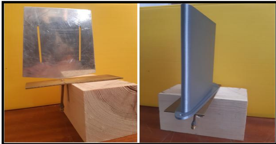
Figure 3.33: Conception de l'antenne monopole avec sa radome et plan de masse.
