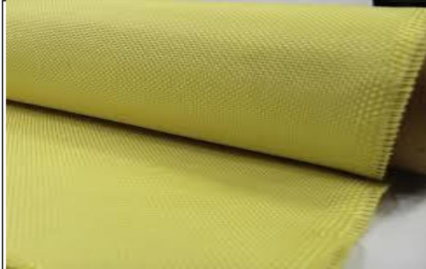
**Figure I. 5:** Fibre d'aramide.
