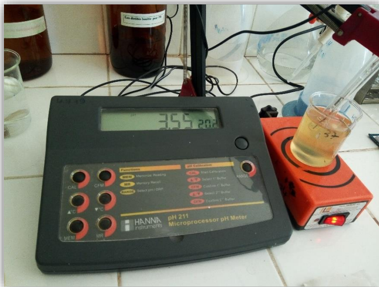
Figure 2.2 : Mesure du pH d'un échantillon de miel
