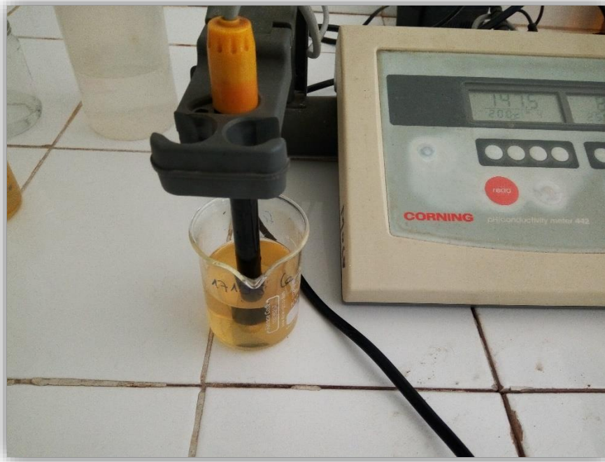
Figure 2.3 : Mesure de la conductibilité électrique
