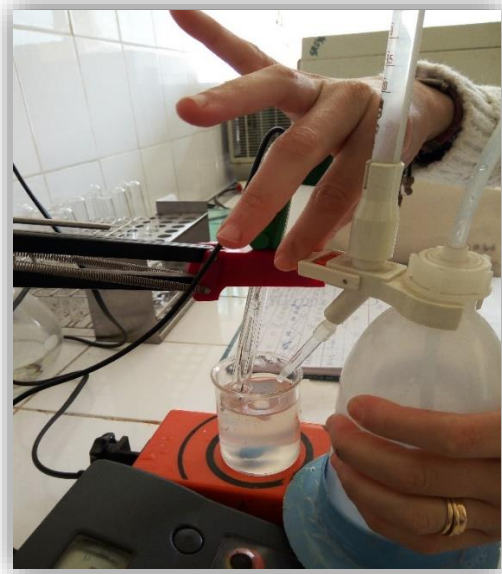
Figure 2.4 : Titration par le NaOH pour faire monter le pH à 8,30
