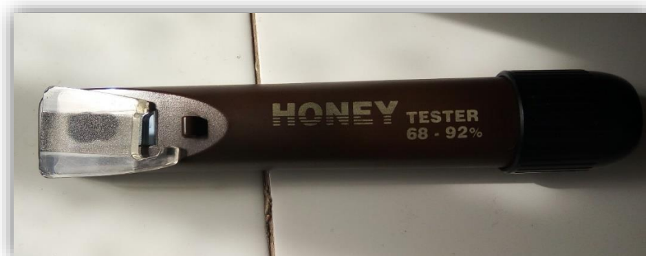
Figure 2.6 : Réfractomètre à main spécial pour le miel
