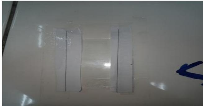
Figure II.1 : Le film de composite PLA-(PEG/TiO<sub>2</sub>)-PLA
