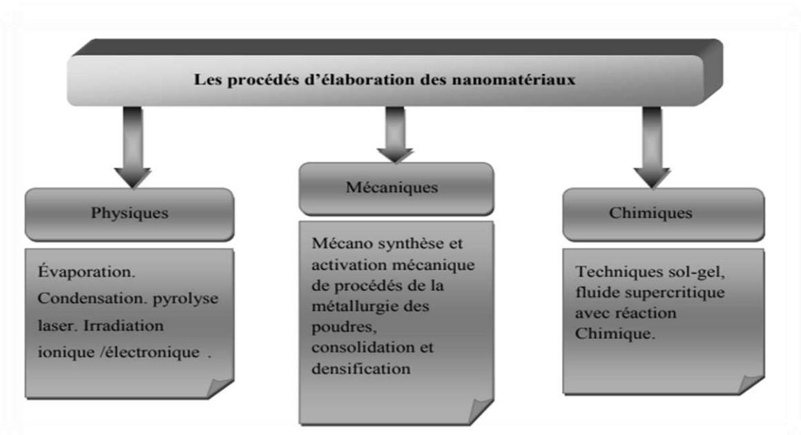
Figure I.4 : Différents procédés d'élaboration de nanoparticules.
