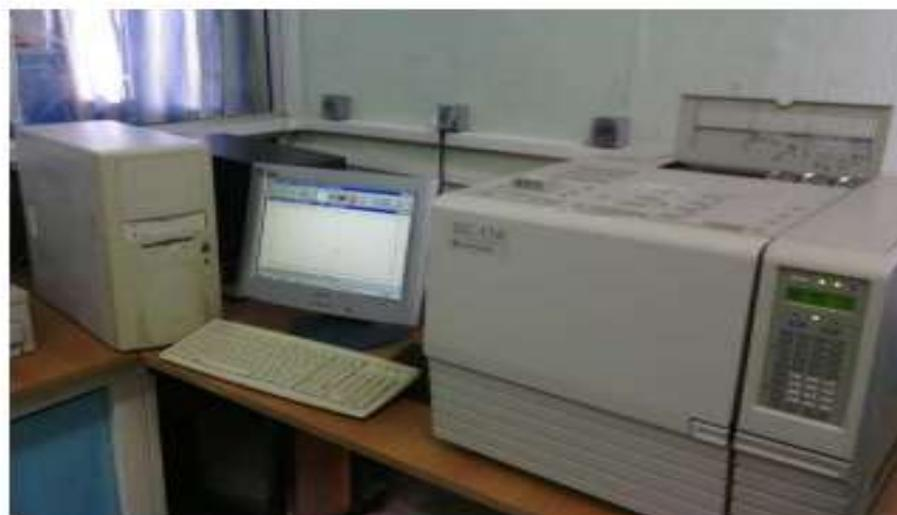
**Figure 17.** CPG utilisée, GC-17 SHIMADZU.
