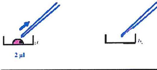
**Figure 24 :** Montée par capillarité dans la paille OPS (Vajta et al, 1998)
