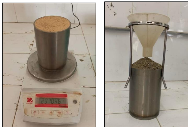
Figure 2.8 : Essai de la masse volumique apparente.
