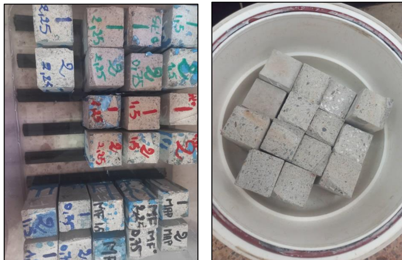
Figure 2.36 : Absorption d'eau par succion capillaire.
