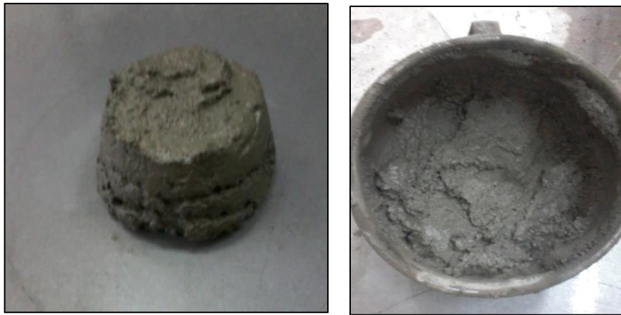
Figure 3.4 : l'état du mortier après l'absorption de leau de gachage par les fibres.
