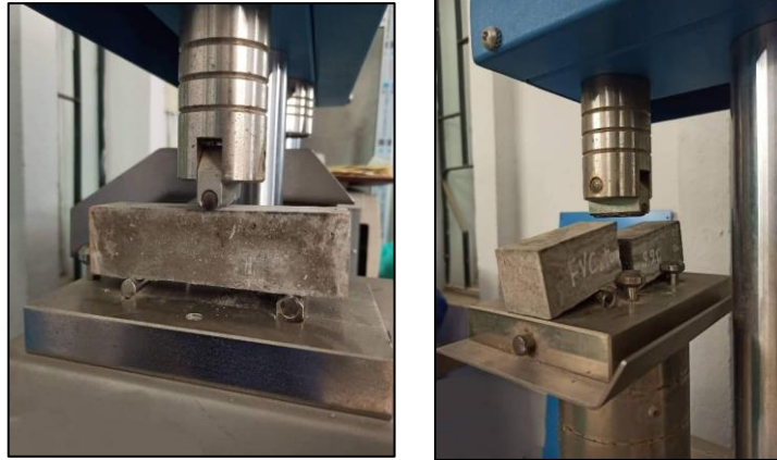
Figure 2.34 : Essai de flexion pour MAP.
