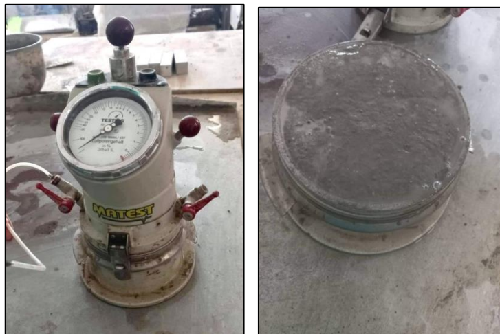
Figure 2.31 : Essai de l'air occlus.
