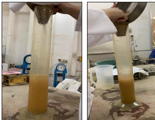
Figure 2.9 : Essai de la masse volumique absolue.
