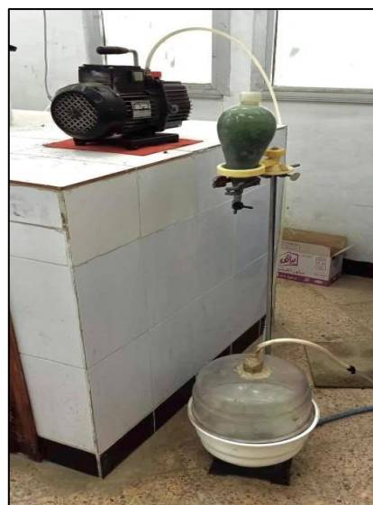
Figure 2.38 : Dispositif de saturation sous vide des éprouvettes.
