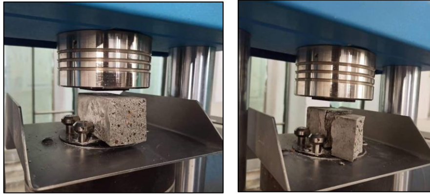
Figure 2.35 : Essai de compression pour MAP.
