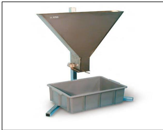
Figure 1.7 : Essai à l'entonnoir en V (V-Funnel). [8]
