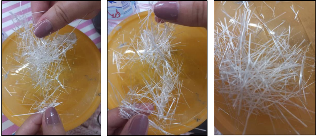
Figure 2.20 : Fibres de verre déchiquetées à la main (FVF).
