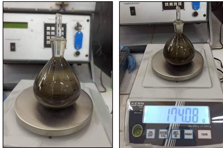
Figure 2.10 : Essai de la masse volumique absolue du ciment.
