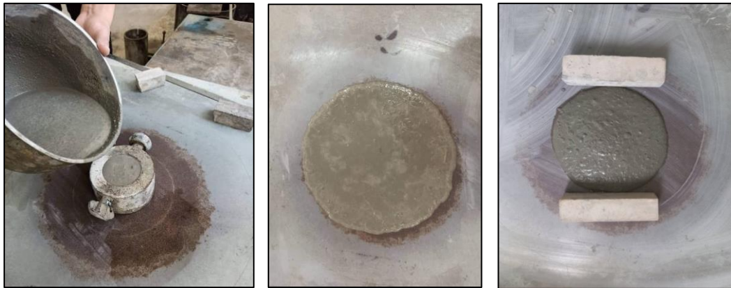
Figure 2.29 : Essai d'étalement au Mini-Cône.
