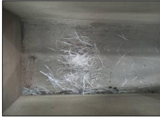
Figure 2.18 : Fibres de verre obtenues après concassage.
