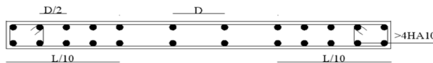
Figure 5.13: Disposition des armatures verticales dans les voiles.
