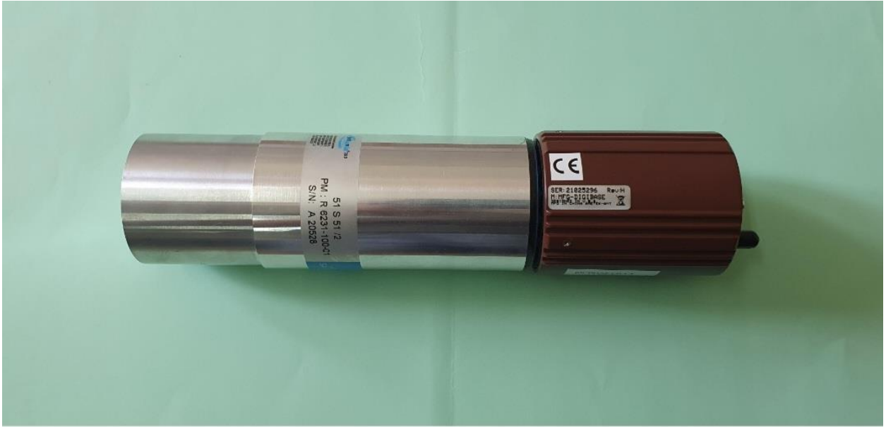
Figure 2. 7: Détecteur à scintillation \text{LaBr}_3(\text{Ce}) \times 2 modèle BrillanCe TM 380 de Saint-Gobain Crystal.
