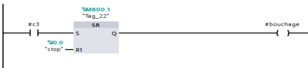
Figure 4.8 : Réseau de bouchage
