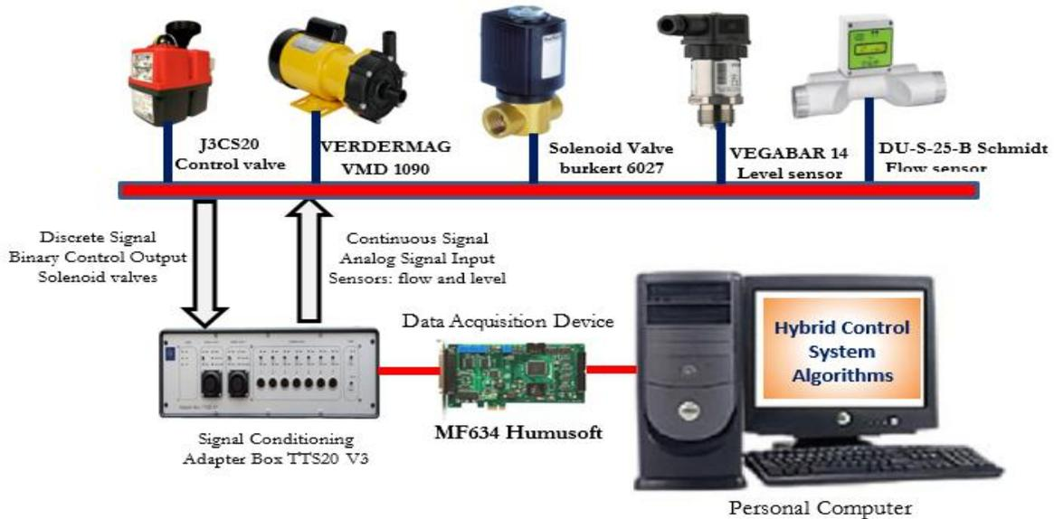
Figure II.2 : Instrumentation du système hybride à trois cuves-sphériques.
