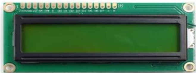
Figure 4.22 : interface de LCD 16x2
