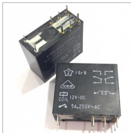
Figure 2.8 exemple de relais DPDT
