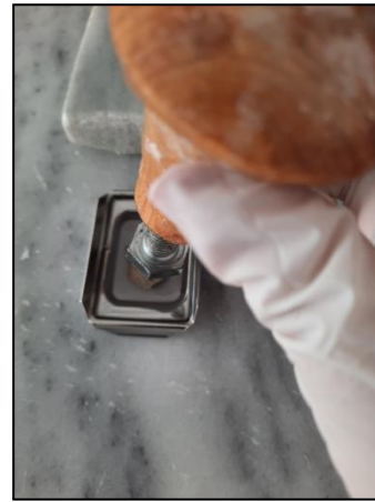
Figure 25 : Dépôt et Immobilisation du prélèvement au centre du moule métallique
