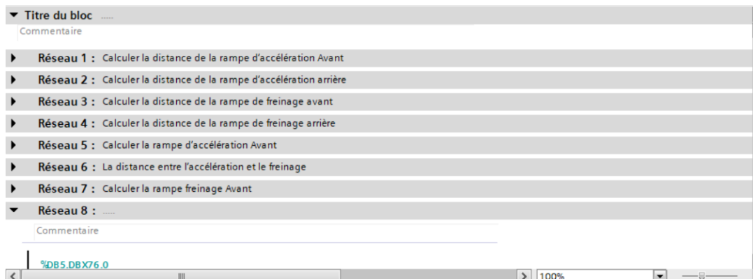
Figure 3.11: Vue des réseaux du bloc FC2
