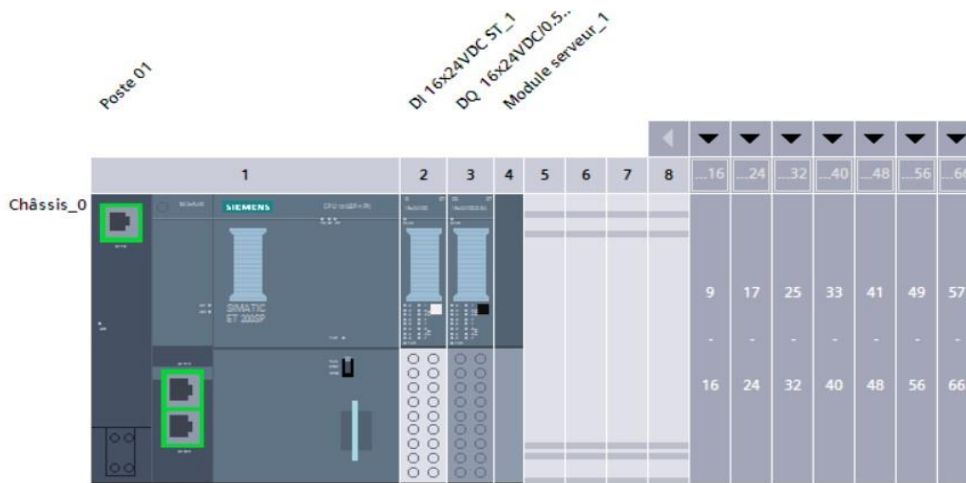
Figure II.15 : Configuration matérielle d'une station ET 200SP CPU
