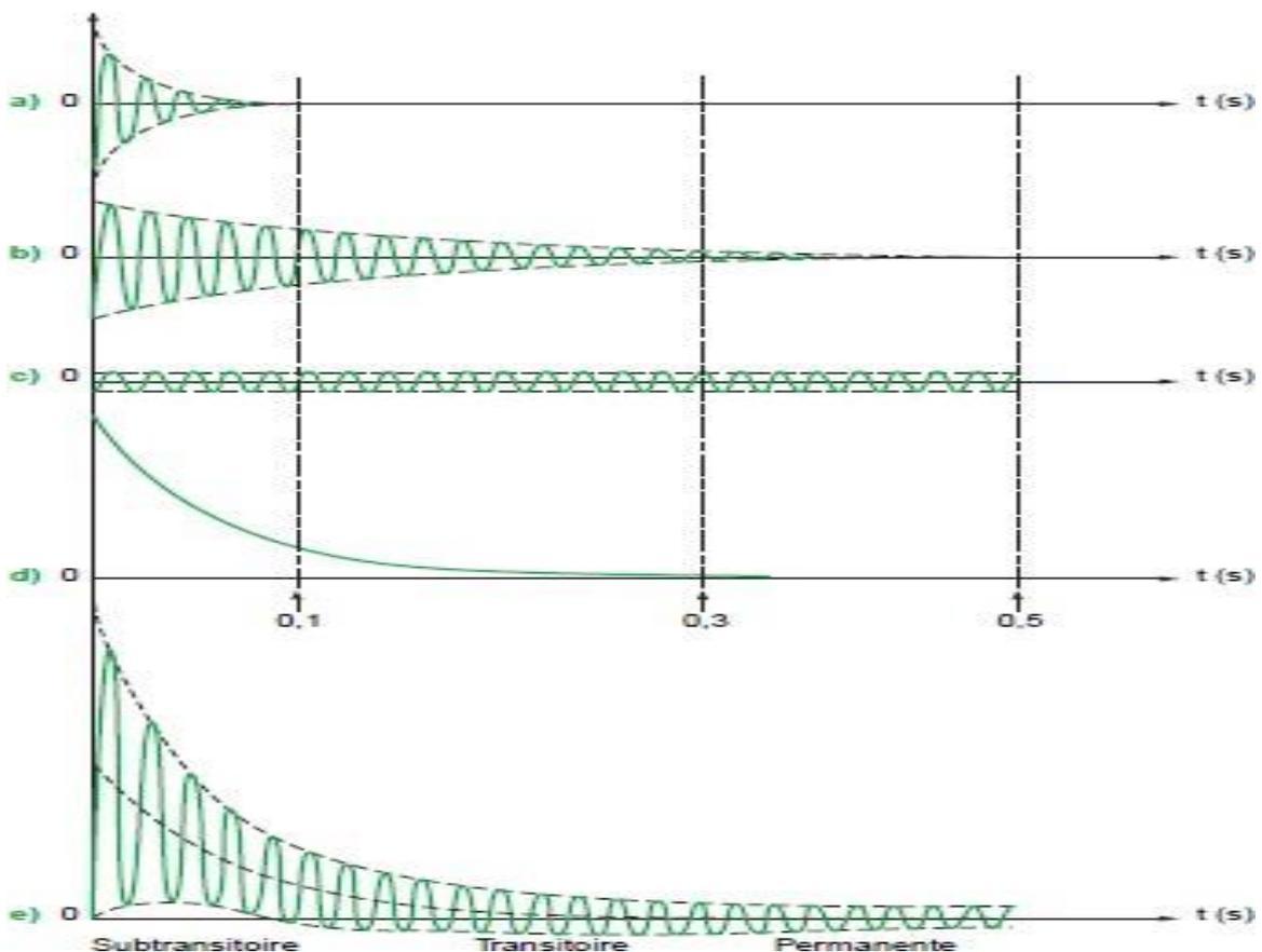
Figure 2.2 : Forme du courant de court-circuit  $I_{cc}$ . [7]
