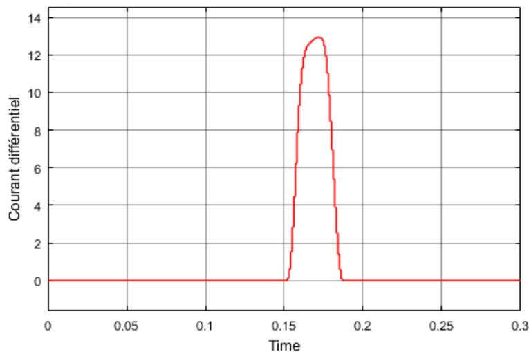
**Figure 4.18 :** Courant différentiel en cas d'un défaut interne.
