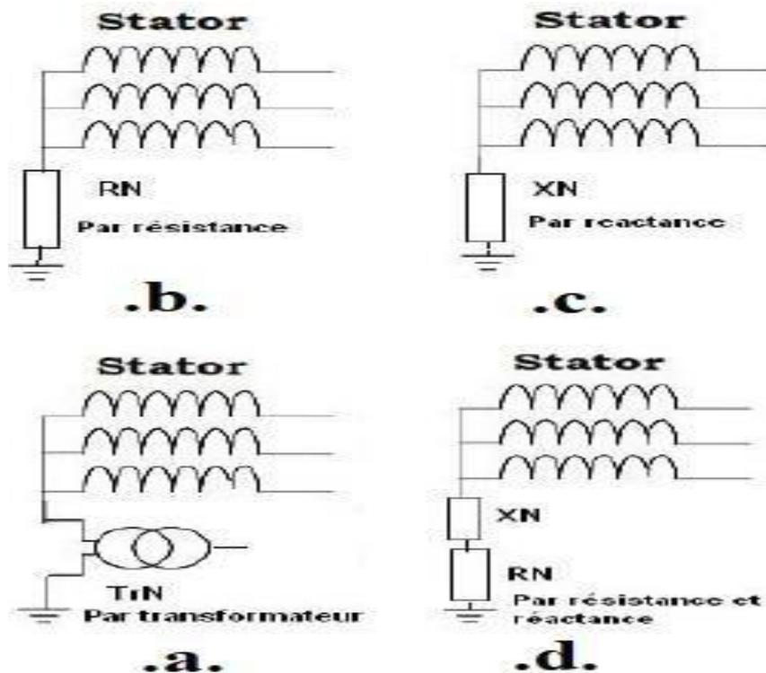
Figure 2.6 : Mise à la terre du stator. [6]
