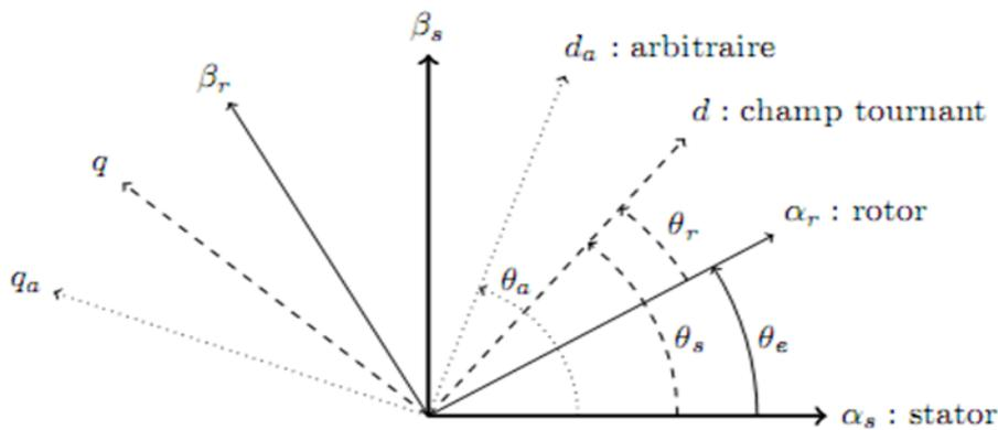
figure 1.6-Différents repères diphasés pour une machine AC
