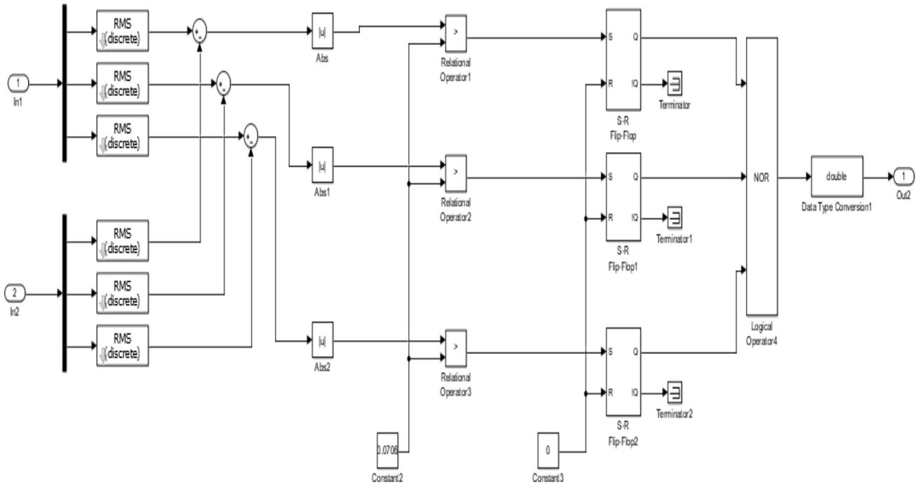
**Figure 4.14 :** Sous-système de la protection différentielle
