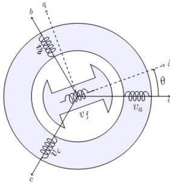
**figure 1.6.2-**Représentation symbolique de la machine synchronisée à rotor bobiné à pôles saillants.
