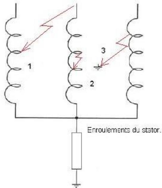
**Figure 3.1** : Les différents défauts affectants le stator. [6]
