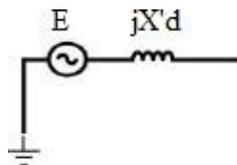
**Figure 4.10 :** Modèle équivalent du stator d'une machine synchrone.
