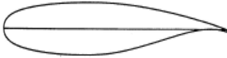
Figure I-20 : Profil supercritique sc(2) 0518
