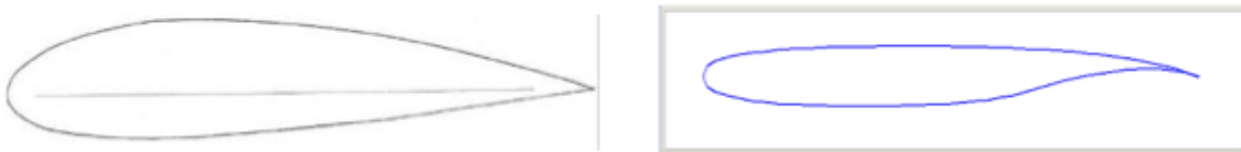
Figure I-17 : Profil symétrique et supercritique
