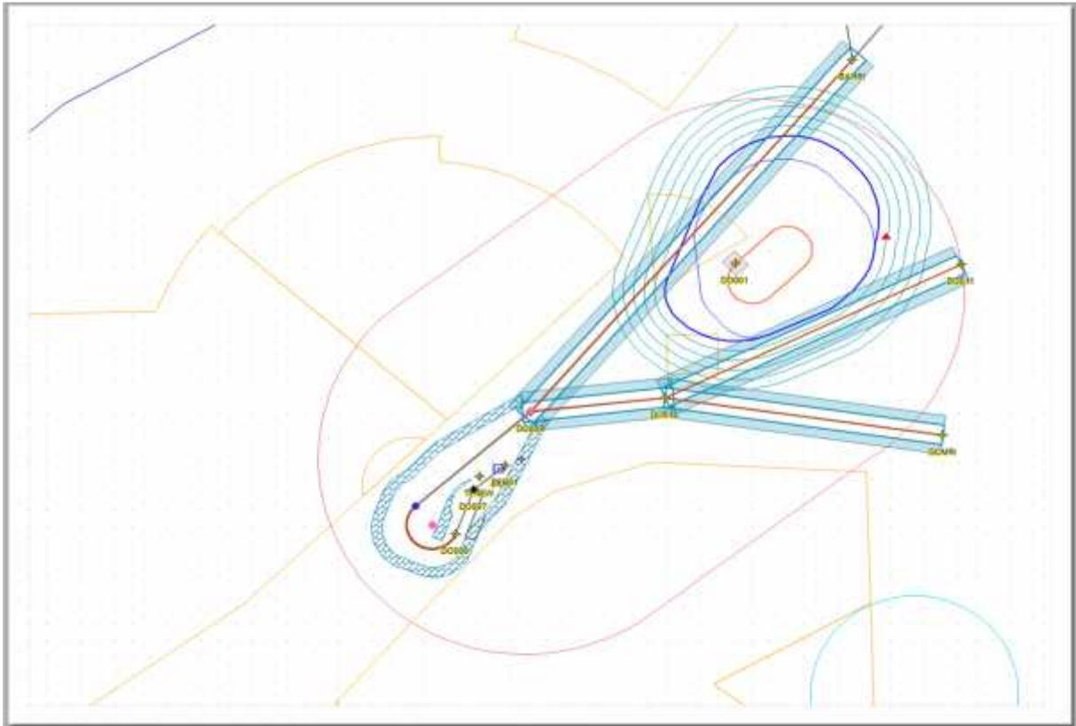
Figure (III.9) Le dessin (avec outil GEOTITAN) des SID RNAV GNSS RWY 07L avec les protections de chaque segment.[13]
