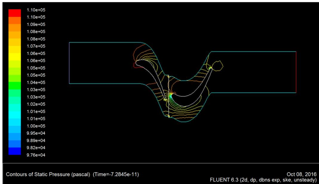
Fig 28 : Contours de la pression statique pour écoulement instationnaire compressible
