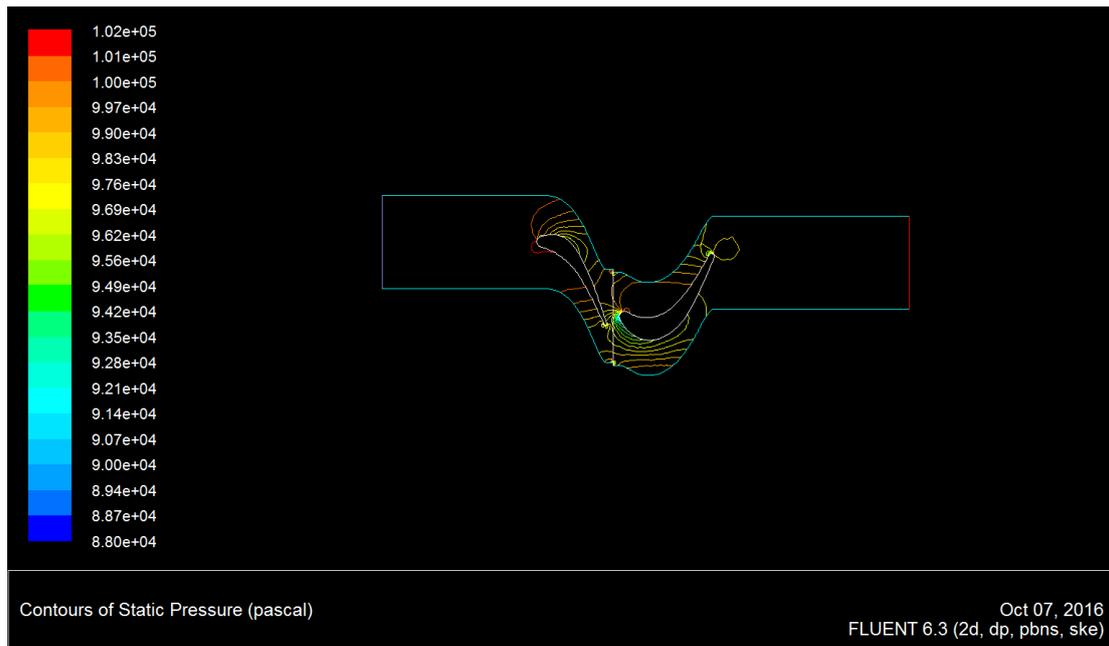
Fig 22 : Contours de la pression statique
