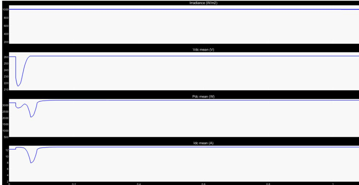
**Figure III.20 : Eclairement, Tension, Puissance et Courant d'un sous champ**
