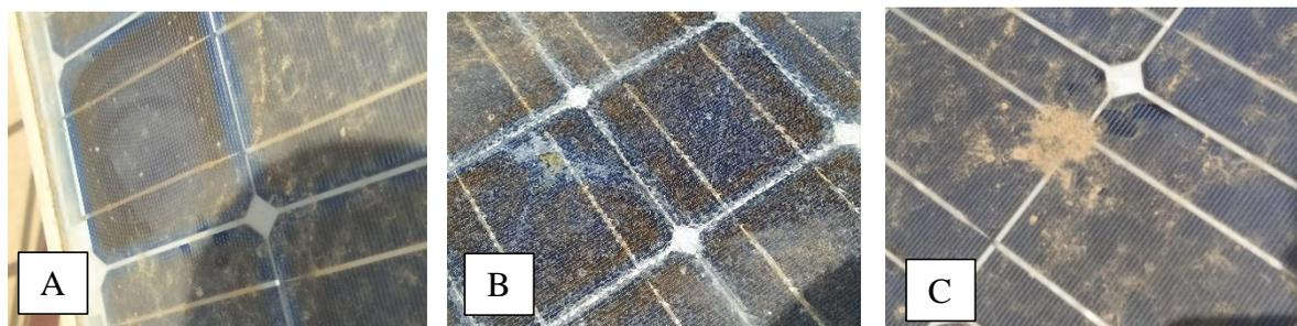
**Figure IV.54 : Etat de quelques cellules PV endommagées au CDER**
