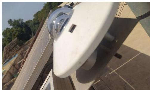
**Figure IV.1 : Pyranomètre**
