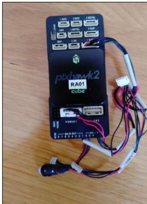
**Figure III-25** : La PixHawk (Cube 2.1) utilisé.
