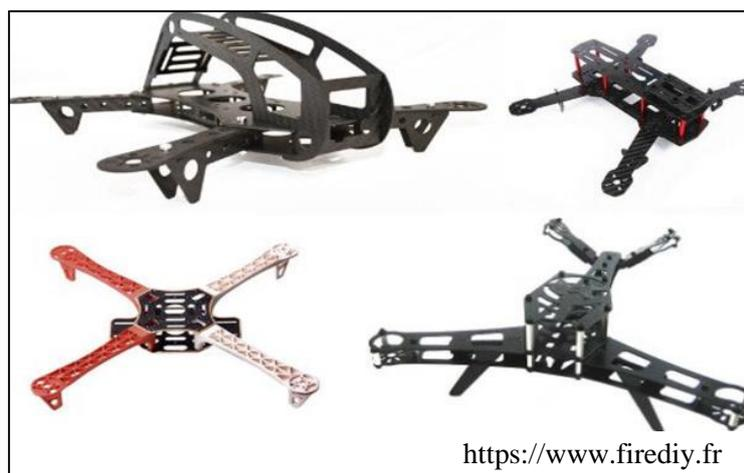
Figure I-18 : Différents types des Châssis.
