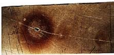
Figure 1.4 : Corrosion par Piqure [4]
