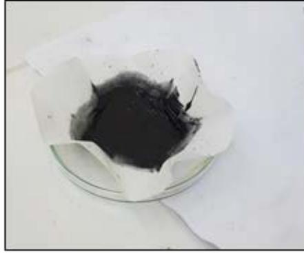
**Figure 13** : Photographie montrant la phase MBene après filtration.
