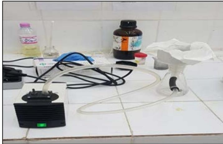
**Figure 11** : Photographie montrant le système de filtration
