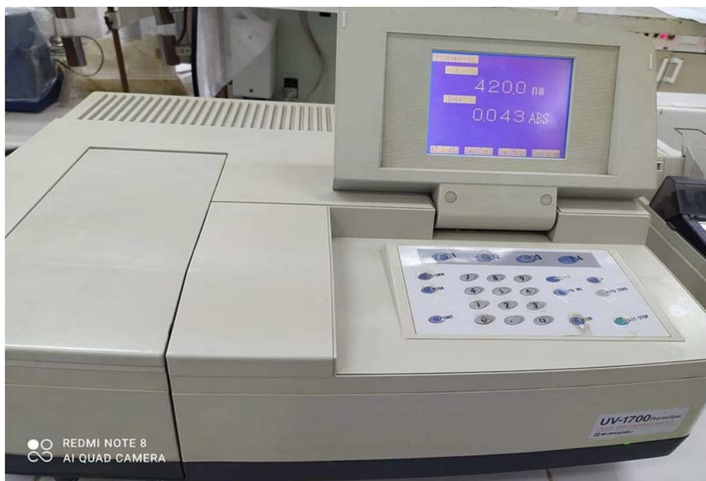
**Figure 18** : Photographie montrant le spectrophotomètre UV-Visible de type SHIMADZU-170.
