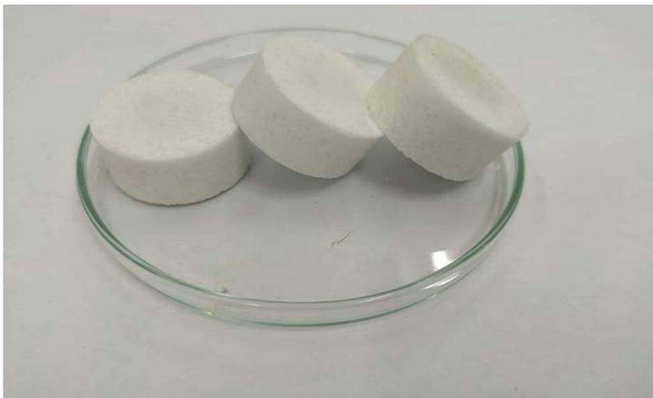
**Figure 9** : Photographie numérique montrant la poudre de (MAB) compactée et encapsulée
