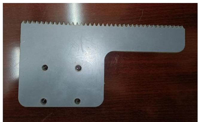
**Figure IV.10: crémaillère modélisée sous SolidWorks et réalisée**
