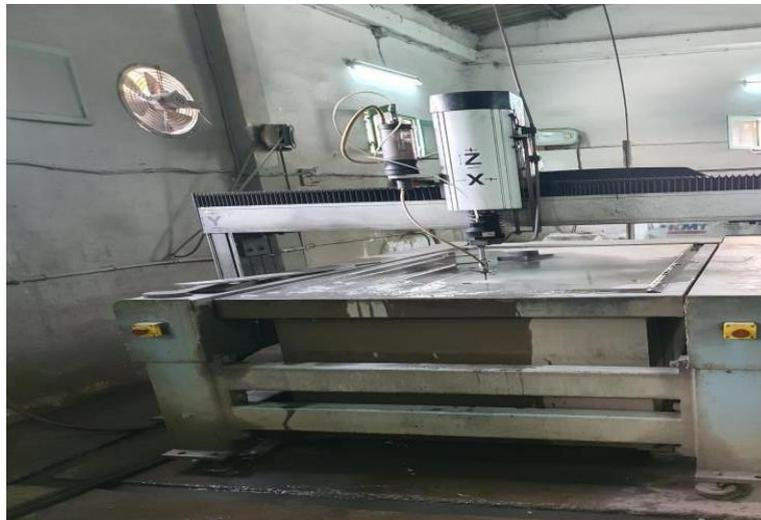
**Figure III.1. La machine EC JET de découpe jet d'eau**
