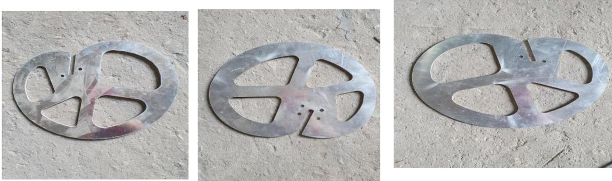
*Figure III.9 : Les cames utilisées dans l'appareil Oxygéné IP réalisé par DS design*
