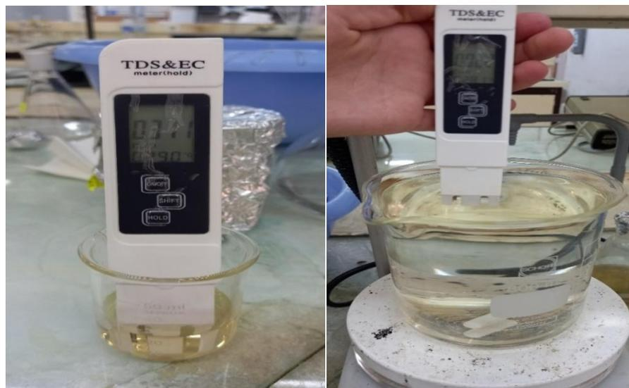
Figure III.9 : Détermination de total des solides dissous de la solution AgNPs.
