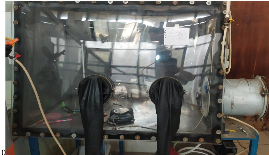
Figure 3.3 : Boîte à gants sous atmosphère d'argon.
