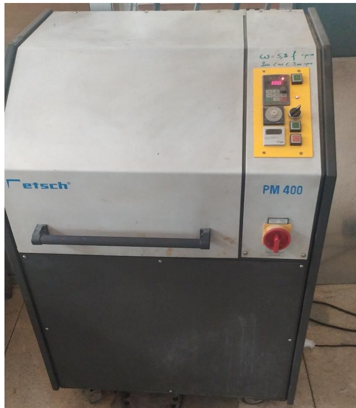
Figure3.1 : Vario broyeur planétaire de haute énergie "Retsch PM 400"
