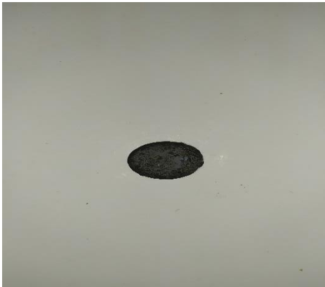
FigureIII.8 : L'alliage après le frittage et l'enlever de sel.
