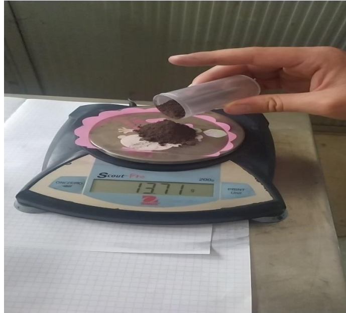
Figure3.5 : la balance de précision 10^{-2}
