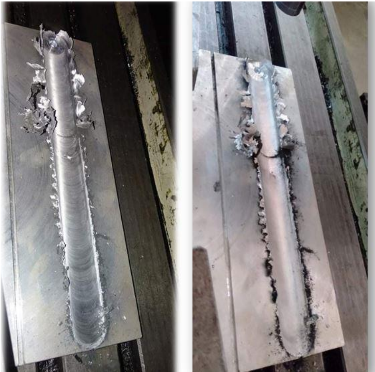
Figure 35: A) Soudage par friction malaxage fsp0 B) soudage par friction malaxage fsp+max
