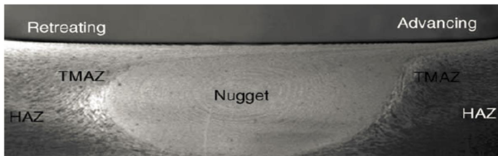
Figure 19: Microstructure des différentes zones dans un joint pendant le FSW (Mishra and Ma 2005)
