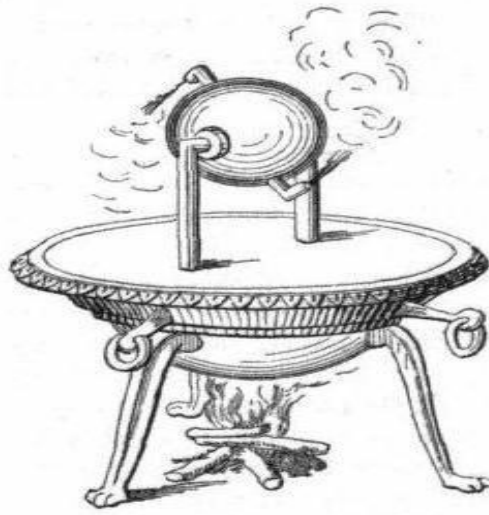
Figure I.2 : chaudière l'éolipile par Héron d'Alexandrie
