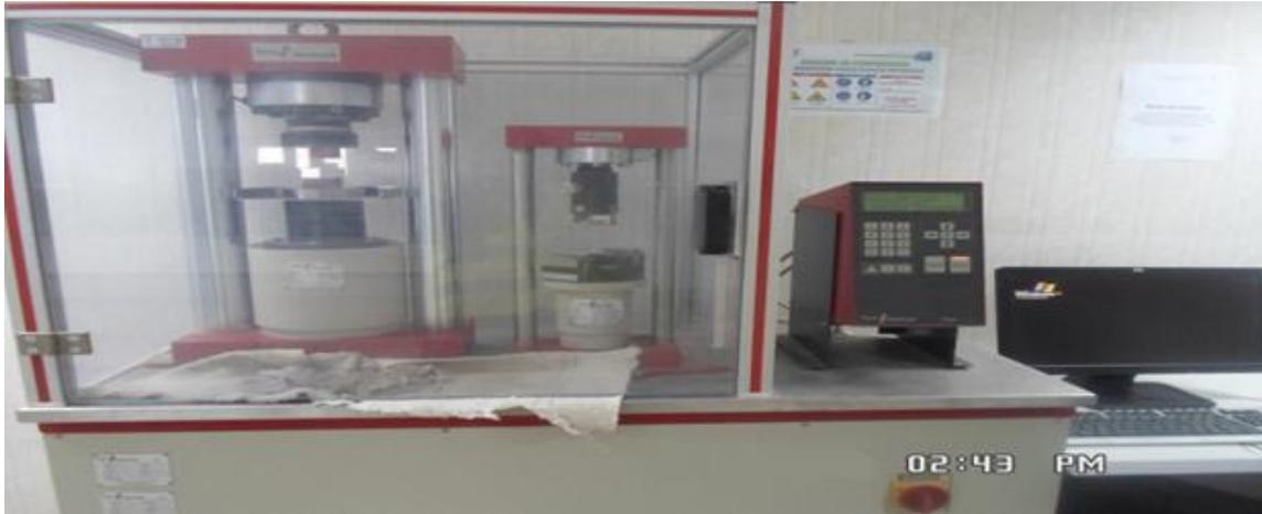
**Figure 9: presse pour les essais de flexion et de compression sur éprouvettes 4×4×16 cm**
