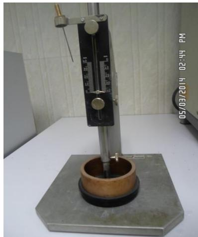
**Figure 14: Appareil de Vicat manuel**
