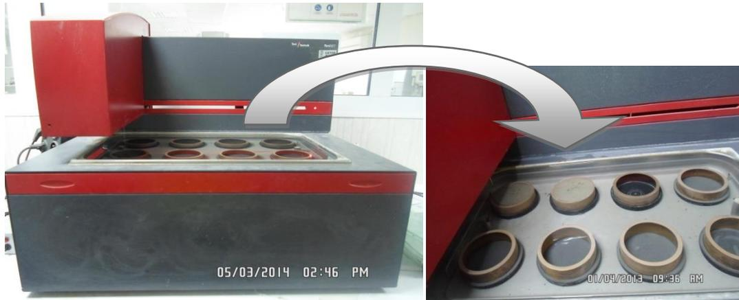
**Figure 16: Appareil de Vicat automatique.**
