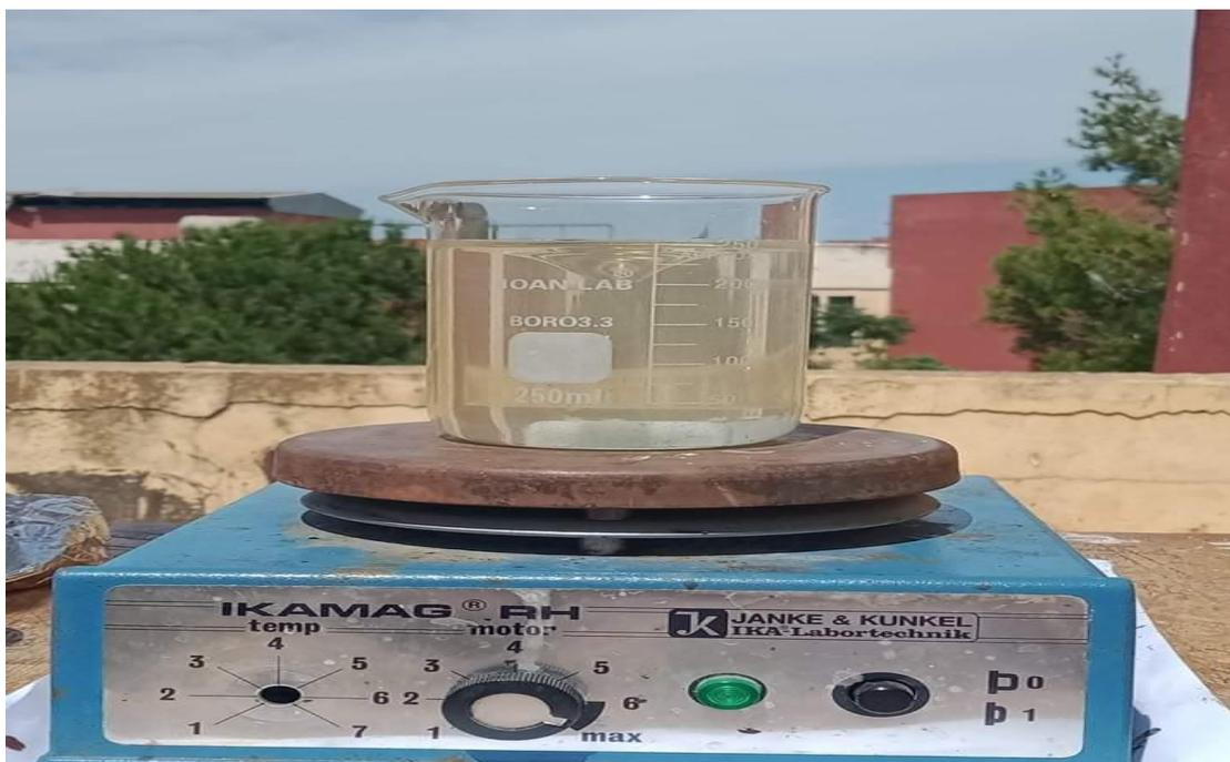
Figure 3.2 : Dispositif expérimental du procédé photocatalytique dans le solaire
