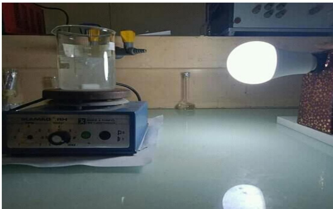
**Figure 3.1** : Dispositif expérimental du procédé photocatalytique dans le UV-visible
